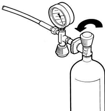
Avb. 11 Подсоединение баллонов сжатого воздуха
