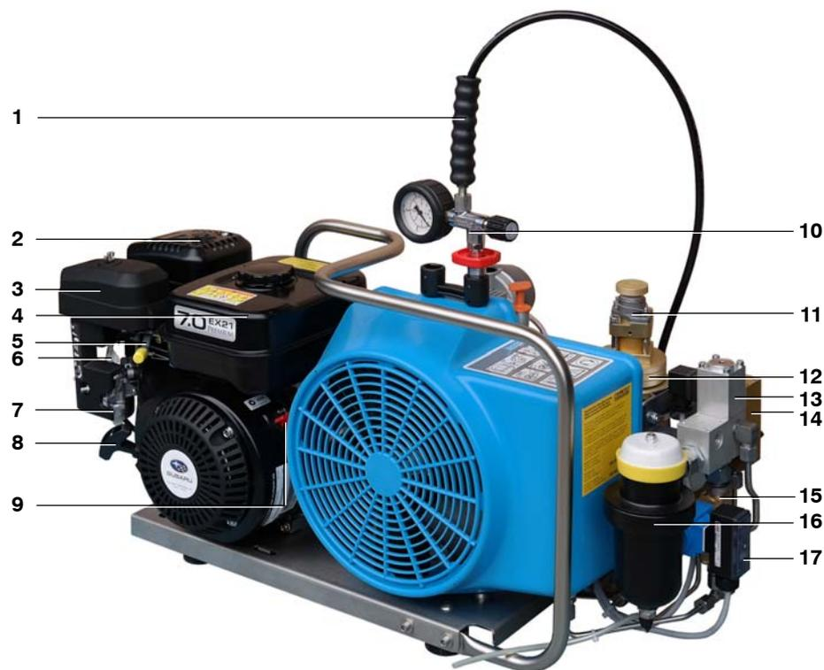
Avb. 2 Компрессорная установка с бензиновым двигателем и автоматической системой выпуска конденсата
